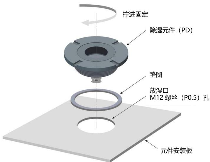
图 1. 安装示意图
